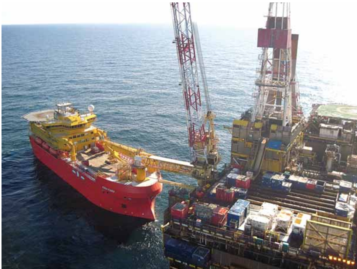
LANDGANG: Her ser man tydelig hvordan arbeiderne kan spasere til og fra jobb mellom båten og plattformen. (Pressebilde).
