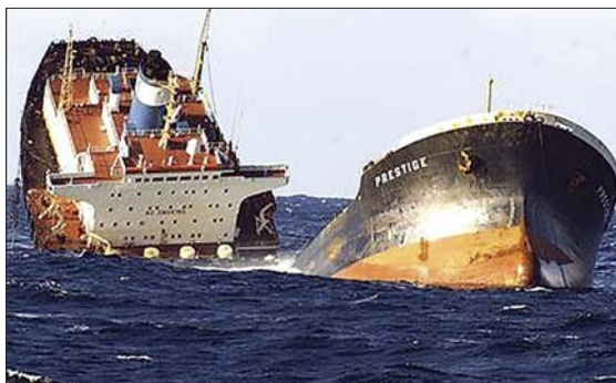
KNACK: Myndighetene nektet "Prestige" å søke ly roligere vann nær kysten. Resultatet var at oljetankeren knakk i to og nesten hele lasten lakk ut i havet. Resten ble med båten ned på 3400 meters dyp når den til slutt sank.
